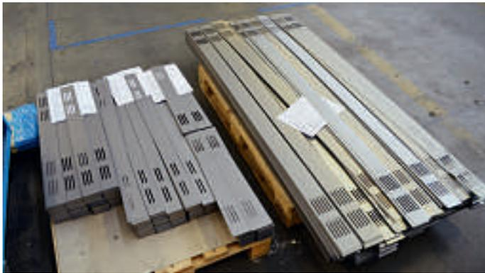
**Rund 10 h Laserschneiden am Stück: Ideale Teile für die mannlose Schicht.**
