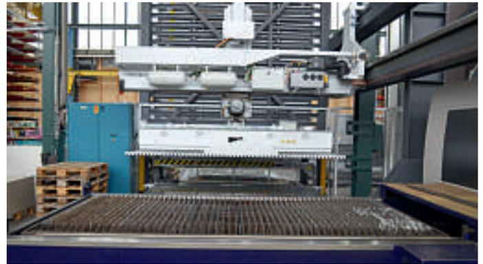
**Die Handlingeinheit übernimmt die Beschickung der Laserschneidmaschine aus dem Palettenregal – ausgelöst durch die Maschine.**
